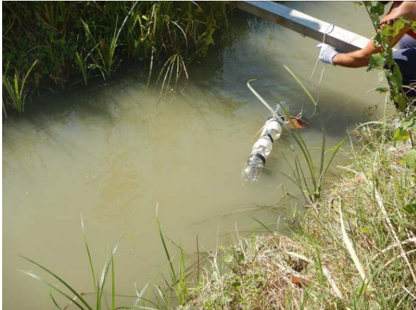
Figura 15 – CO-1: fissaggio del SA al palo in legno trasversale al canale.
