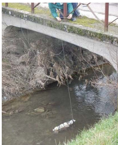
Figura 20 – DFNC-2: ancoraggio dei substrati al ponte.
