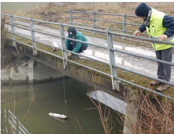
Figura 50 – CA-4: fissaggio dei substrati al ponte.
