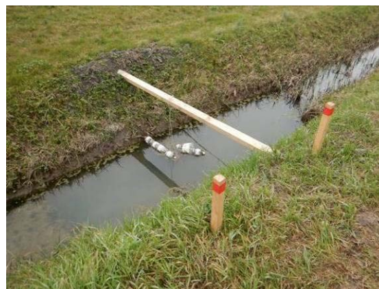
Figura 6 – CO-1: substrati ancorati al palo in legno.
