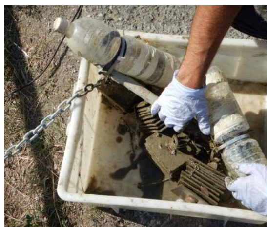
Figura 48 – CABM-3: substrati prima del lavaggio delle lamelle di faesite.
