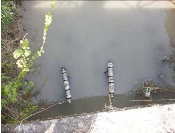
Figura 24 - DFNC-2: ancoraggio dei substrati al ponte.
