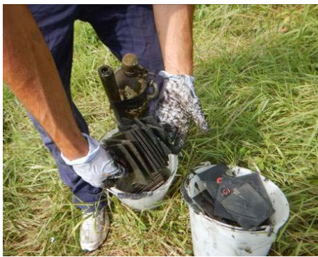
Figura 13 – CO-1: separazione delle lamelle di faesite prima del lavaggio.
